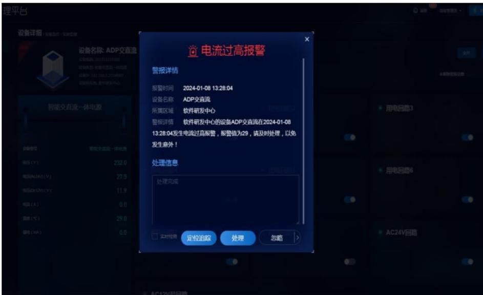
当系统监测到过欠压、电流过高、温度过高、漏电电流过大等异常状态时，会自动弹框报警。可依据区域、时间段、设备报警类型统计管理告警信息。
